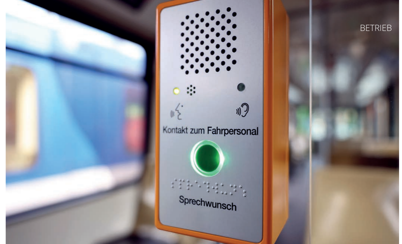
Bis zum Frühling 2022 wird die neue Fahrgastgesprächstation in 53 TW 6000 verbaut.
